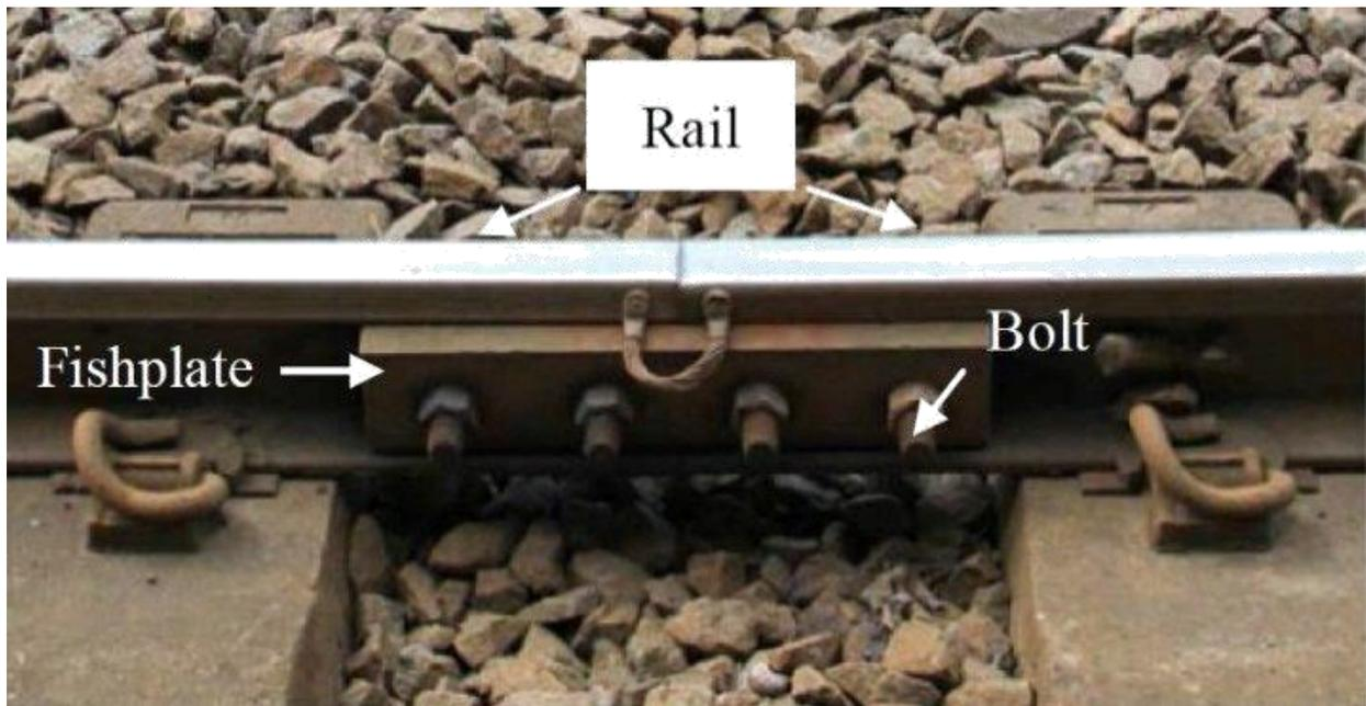
I cavi si possono trovare in molte giunzioni delle rotaie, sia come un singolo cavo che collega le rotaie alla parte superiore della barra di giunzione, sia come due cavi che escono da ogni lato della barra di giunzione. Tagliare uno o più di questi fili nelle varie giunzioni interferisce con il circuito e mette il blocco del segnale nello stato "occupato". Non c'è bisogno di comprare un cavo di rame per questo, tutto ciò che serve è un buon paio di forbici o un piccolo tagliabulloni.
